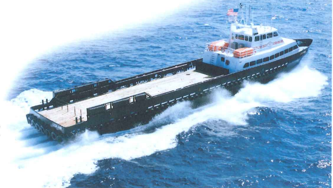
"MV Lisa Ann" 44m 油田掘削クルー船、 USA、ロサンゼルス、モーガンシティ、 クワッド HM571 ウォータージェット
