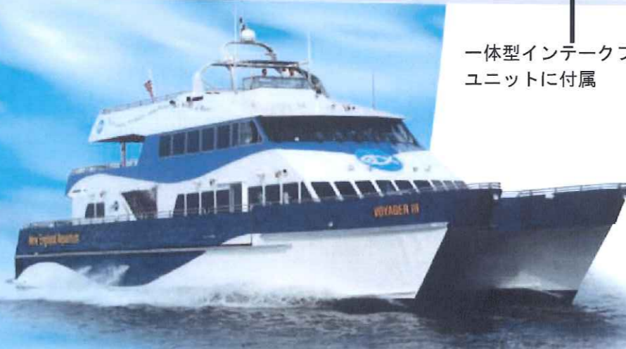
"Voyager III" 34m 双胴船、USA、ボストン、ニューイングランド水族館、 クワッド HM461 ウォータージェット
